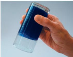
So genannte „Superabsorber“, die in die Saugkörper der Inkontinenzprodukte eingebettet sind, binden Flüssigkeit absolut zuverlässig.
